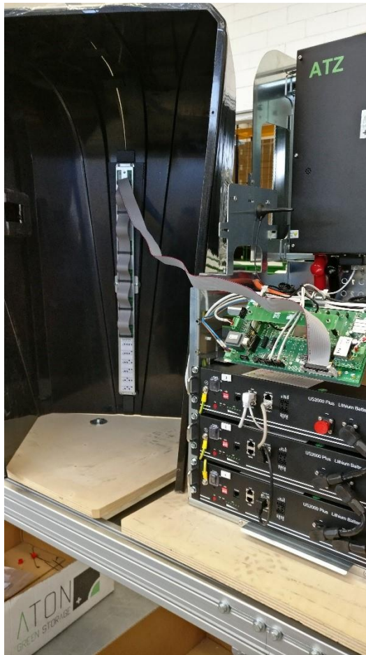
Figura 64 - Striscia LED correttamente installata
