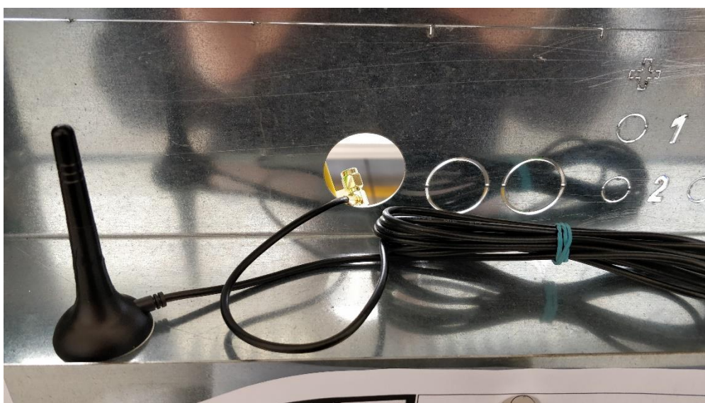
Figura 18 – Passaggio cavo antenna in foro di passaggio su pannello posteriore; completare con idoneo pressacavo
