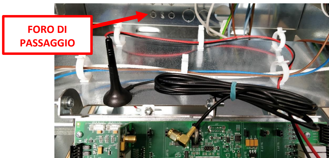
Figura 17 – Identificazione foro di passaggio cavo antenna su pannello posteriore
