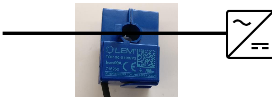
Figura 22 – CT1: verso di installazione indifferente
