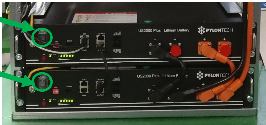
Figura 70 - Interruttori "0/1" moduli batteria: settare ad "1"
